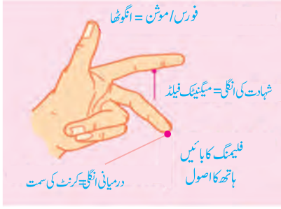
شکل 17.6: میگنیٹک فیلڈ میں پڑے کرنٹ لے جانے والے کنڈکٹر پر لگنے والی فوس کی سمت
